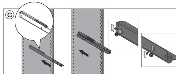
③ レール内側のスライドバーを手前に引き出し（図d）、棚板を乗せます（図e）。棚板左右 i の位置にある下向きのフックをレール内側のスライドバーに配置した四角い穴に入れ、奥へ滑り込ませて固定します（図 i）。続けて棚板手前下側の丸い突起を、スライドバーの丸い穴に差し込み固定します（図 ii）。本体から棚をはずす際は、逆の手順となります。棚板手前を持ち上げ、図 ii の突起を穴からはずしてから棚板を手前に引き、棚板奥の下向きフックをスライドバーからはずします。
