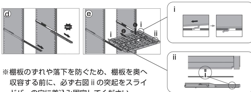
※ 棚板のずれや落下を防ぐため、棚板を奥へ収容する前に、必ず右図 ii の突起をスライドバーの穴に差し込み固定してください。
