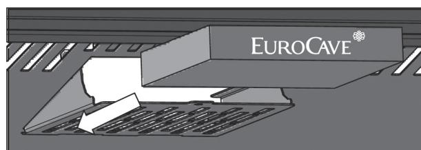
④新しいもののプラスチックカバーを外し、ロゴを手前にして挿入してください
