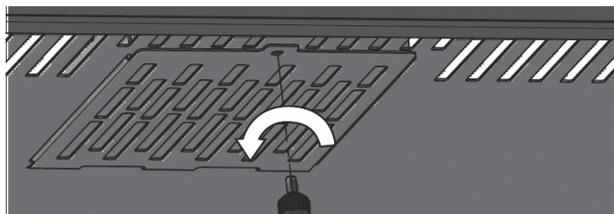
①操作盤下のフィルタースペースのビスを外します
