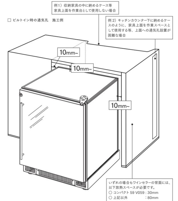
ワインセラーを家具等にビルトインされる際は、ワインセラー背面に熱がこもらないよう、通気孔の設置が必要です。ワインセラーの上面（例1）、背面（アイランドキッチンの場合等）、側面（例2）等のいずれか1箇所以上に通気孔を設けてください。ビルトイン施工時はホームページまたはお電話にて承認図をご請求ください。
