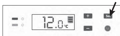
3. 温度が点滅している間に、**+** / **-** のボタンを押して、5秒以内で好みの温度に設定を変更してください。5秒を超えると、表示は自動的に庫内温度に戻ります。
